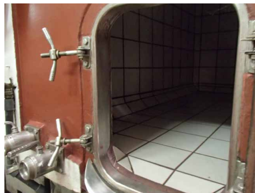
▲セメントタンクの内部に貼られたタイル 清潔に保たれています
